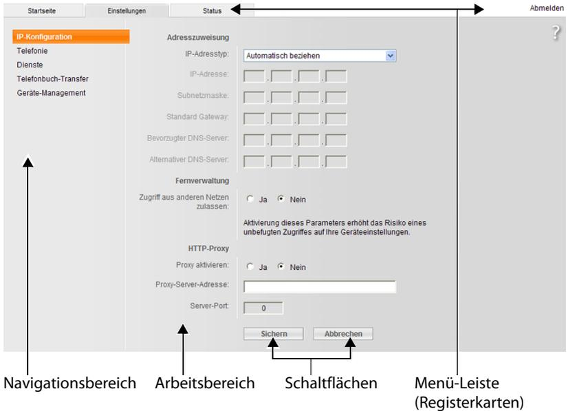
Bild 2 Beispiel für den Aufbau einer Web-Konfigurator-Seite
